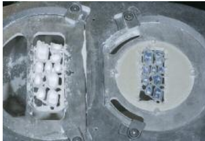
Abb. 19 So sieht es aus, wenn man den Zirkonblock optimal ausnutzt
